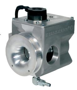
Sein in weitem Bereich variabler Ringspalt erlaubt die präzise Einstellung des Luft-Brenngas-Mischungsverhältnisses für verschiedene Gasarten. Die Venturibasierte Gasmischstrecke mit strömungsgünstiger Gas-/Luftführung weist nur geringe Druckverluste auf und bietet homogene Gemischbildung über den gesamten Drehzahl- und Lastbereich. Dies optimiert Laufqualität, Wirkungsgrad und Emissionen für jeden Arbeitspunkt eines Motors und garantiert zuverlässiges Startverhalten.
