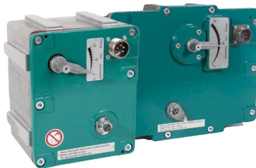
Herzstück der Stellgeräte ist jeweils ein Gleichstrom-Scheibenläufermotor der bereits ein starkes Drehmoment in beide Drehrichtungen entwickelt. Durch ein Untersetzungsgetriebe wird dieses noch verstärkt. Aufgrund des geringen Trägheitsmomentes werden aber dennoch kurze Stellzeiten erzielt.
