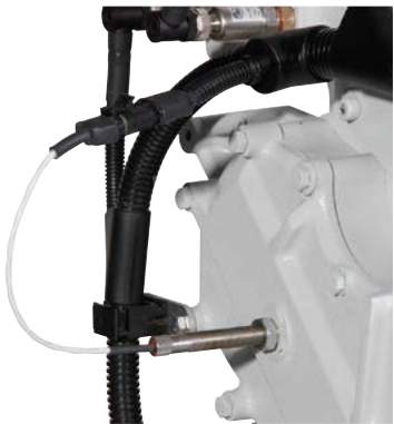
Pick-up an Motor installiert
