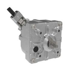
Arbeitstemperaturbereich unterscheiden. Beide Geräte arbeiten ohne Getriebe direkt auf die Welle und bieten daher sehr kurze Stellzeiten. Auf der Welle stehen einem mehrpoligen Dauermagnetsystem radial mehrere Arbeitsspulen gegenüber. Die Anordnung ermöglicht kräftige und gleichmäßig starke Drehmomente über den gesamten Stellbereich in beide Drehrichtungen.
